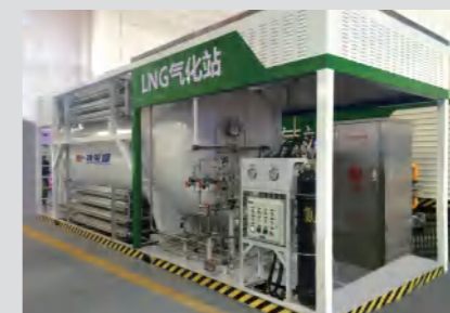
LNG集装箱式气化站 LNG Container Type Gas Station
